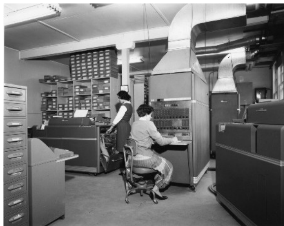
Le Centre d'informatique, 1958. Notez le réseau de conduits nécessaires pour refroidir l'air à l'intérieur du processeur à tubes électroniques. AUO-PHO-NB-32-11.
